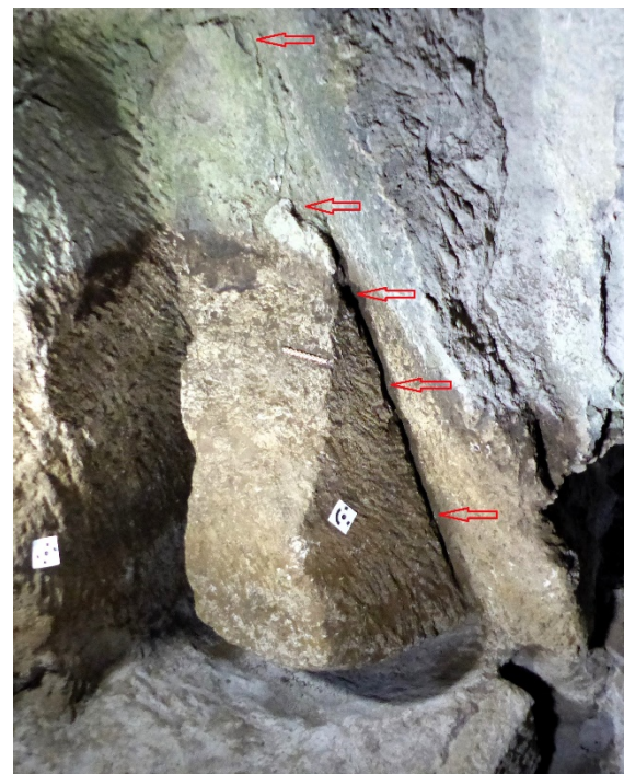
Fig. 12 – Vue du sondage 2 des carrières du Cliersou avec le sarcophage cassé, emplacement des principales emboîtures de coins, PCR Trachyte Martin/Gaime 2016.
